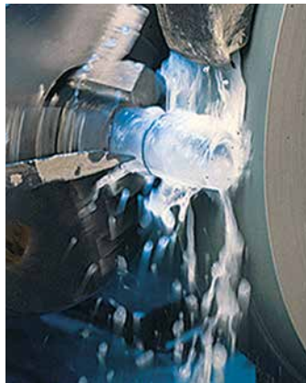
NS-Kerne werden auf halbautomatischen Rundschleifmaschinen weiterbearbeitet.
